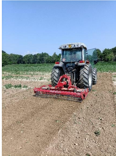
Figura 1. Erpice rotante utilizzato per la terminazione meccanica della falsa semina
